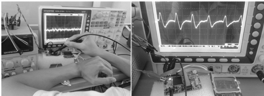
Hình 12. Thử nghiệm đo đạt trên thiết bị với tín hiệu thu được trước (trái) và sau (phải) khi đi qua các bộ lọc nhiễu và khuếch đại
