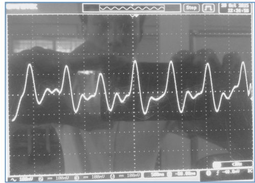
Hình 14. Kết quả thu được tại ngõ ra cuối khi LED hồng ngoại sáng
