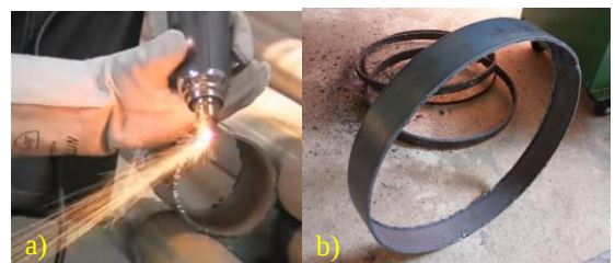
Hình 13. Sản phẩm cắt thủ công (a) và cắt tự động (b)
