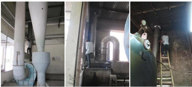
Hình 1. Lấy mẫu khí trong ống khói các lò hơi
