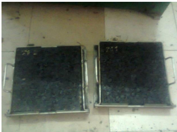
Hình 3. Chuẩn bị mẫu thí nghiệm kháng hàn lún
