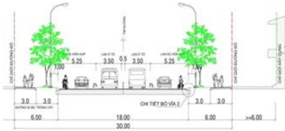
Hình 11. MCN đường đoạn qua các công trình công cộng
