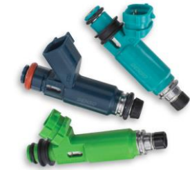
Hình 6. Vòi phun điện trở cao sử dụng trên động cơ 1ZZ-FE
