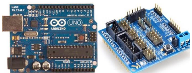
Hình 5. Mạch Arduino Uno R3 (trái) và Sensor Shield (phải)
