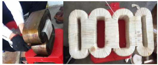
Hình 12. Công đoạn hoàn thiện mạch từ
