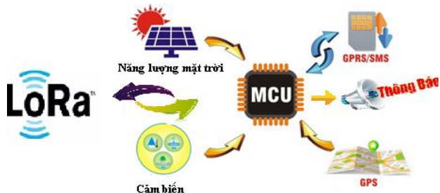
Hình 2. Cấu trúc của node cảm biến trung tâm
