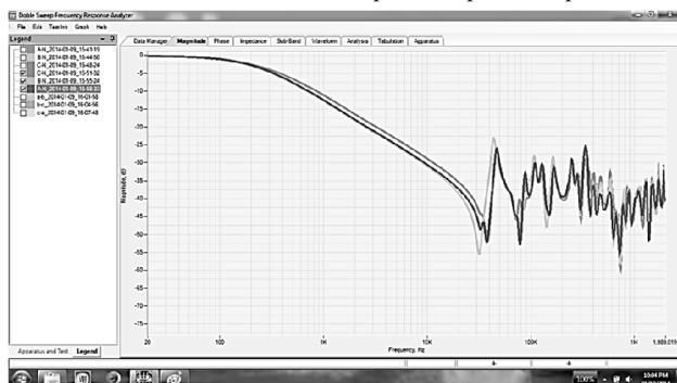
Hình 9. SFRA được thực hiện với các pha AN, BN, CN, phía hạ áp nối ngắn mạch
