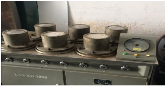
Hình 1. Thí nghiệm xác định cấp chống thấm bê tông
