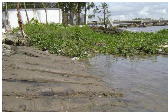
Hình 3. Thử nghiệm thảm cát bảo vệ bờ trên sông Sài Gòn
