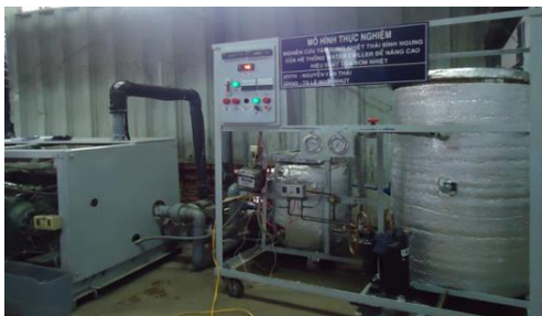
Hình 3. Hệ thống thí nghiệm bơm nhiệt cấp nước nóng WTW
