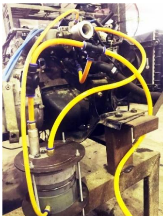
Hình 1. Sơ đồ mặt cắt dọc động cơ sau khi cải tạo (a) và lắp đặt hệ thống cung cấp biogas lên động cơ (b)
