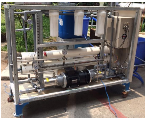
Hình 7. Hệ thống lọc nước biển thử nghiệm với kích thước 1625 x 540 x 1040(mm)
