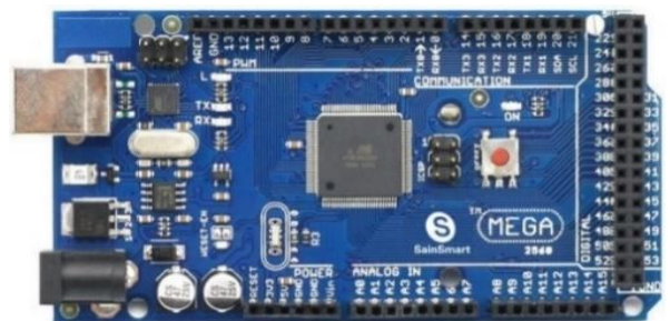
Hình 16. Vi điều khiển Arduino Mega 2560
