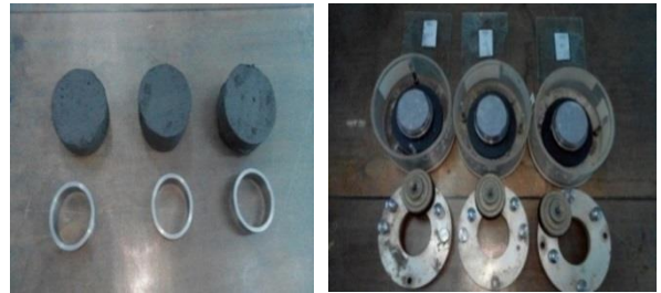
Hình 5. Gia công và cho mẫu vào hộp nén
