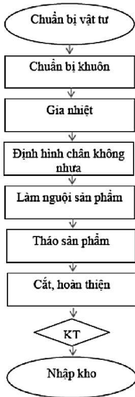
Hình 10. Sơ đồ quy trình tạo hình nhiệt
