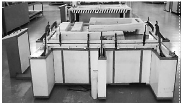
Hình 11b. Bàn hút định hình chân không và khuôn
