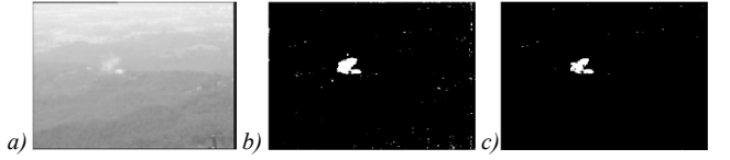
Hình 3. Các kết quả thu được: a) ảnh gốc từ video có đám khói; b) ảnh different nhị phân và c) ảnh tổng hợp thu được
