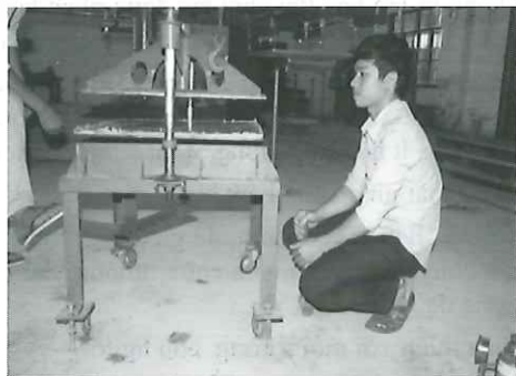
Hình 2. Tháo khuôn panel
