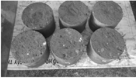
Hình 2. Mẫu CPTN gia cố xi măng sau khi chế bị theo phương pháp Proctor
