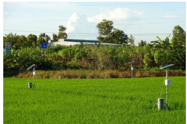
Hình 13. Các nút cảm biến lắp đặt trên ruộng lúa tại Thị xã Ngã Năm, tỉnh Sóc Trăng
