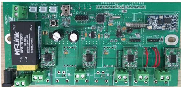
Hình 6. Mạch điện bộ xử lý chính của Nút cảm biến
