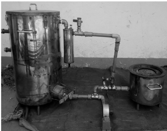
Hình 1. Bếp hóa khí sinh khối và các bộ phận của nó
