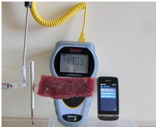
Hình 5. Hình ảnh đo thời gian trễ nhiệt của kim tạo cầu băng
