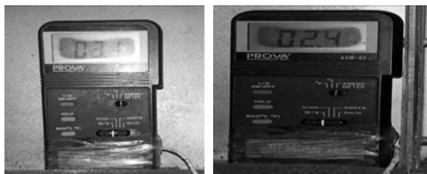
Hình 5. Thiết bị đo tốc độ gió trong tủ IQF
