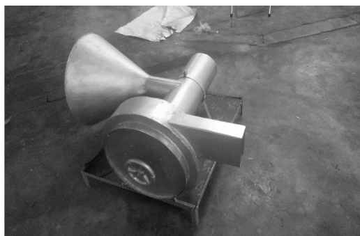
Hình 10. Chế tạo thực tế máy lạnh nhờ hiệu ứng xoáy
