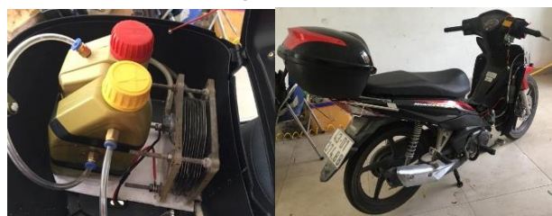
Hình 4. Lắp đặt bình sinh khí HHO kiểu khô
