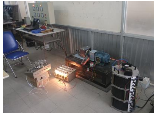
Hình 11. Đo lường LSPSM 2,2 kW thí nghiệm
