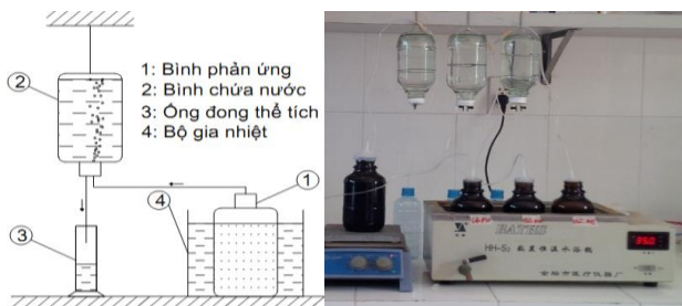
Hình 1. Mô hình kỵ khí 500ml – chế độ gián đoạn
