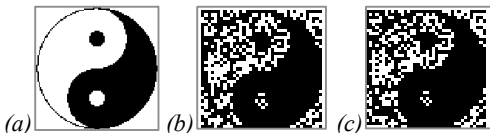
Hình 4. Ảnh gốc (a) và ảnh nhận được khi tệp âm thanh chứa tin bị thêm nhiễu hạt tiêu (b) và nhiễu đốm (c)
