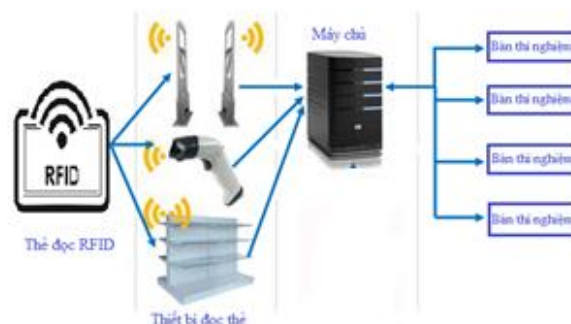
Hình 2. Mô hình hoạt động RFID tích hợp IoT
