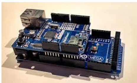
Hình 5. Dùng Arduino Atmega2560 và Ethernet shield [12]
