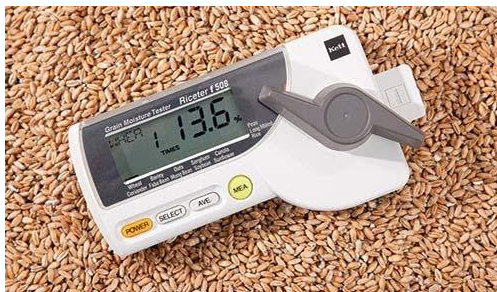
Hình 5. Thiết bị xác định độ ẩm Kett F511
