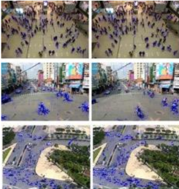
Hình 2. Kết quả ước lượng vận tốc của các điểm chuyển động thuộc đám đông. Véc-tơ màu xanh biểu diễn chiều và độ lớn của véc-tơ vận tốc
