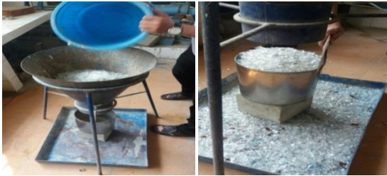
Hình 2. Sàng phân loại thủy tinh và thí nghiệm xác định khối lượng thể tích xốp của thủy tinh
