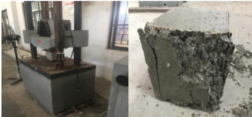
Hình 3. Thí nghiệm phá hoại mẫu bê tông cốt liệu thủy tinh
