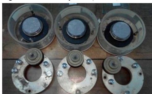
Hình 1. Chuẩn bị mẫu nén cố kết tiêu chuẩn
