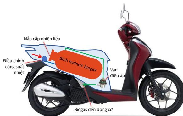
Hình 7. Sơ đồ bố trí hệ thống cung cấp nhiên liệu hydrate biogas cho xe gắn máy
