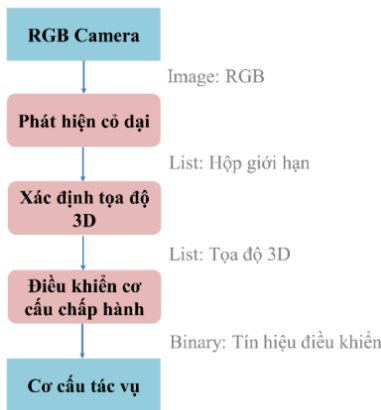
Hình 1. Sơ đồ khối của mô hình robot diệt cỏ tự động
