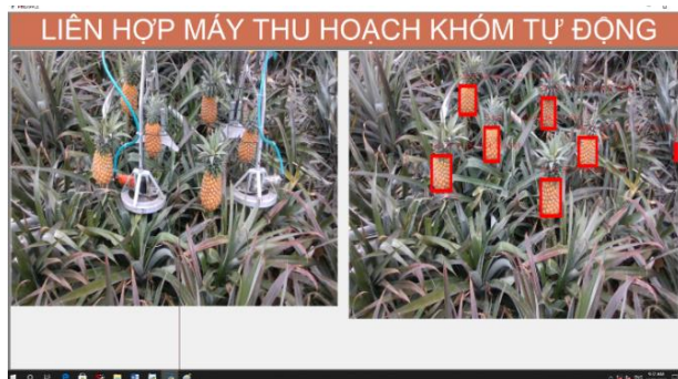
Hình 7. Kết quả nhận dạng và thu hoạch từ thực địa được đưa từ camera về máy tính chủ (Ảnh phải: Các trái khóm được nhận dạng; Ảnh trái: Hai tay cắt tiếp cận hai trái khóm)
