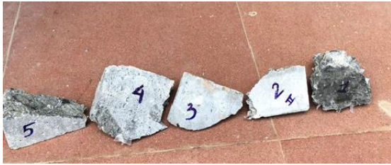
Hình 3. Chuẩn bị mẫu để đo độ hút nước
