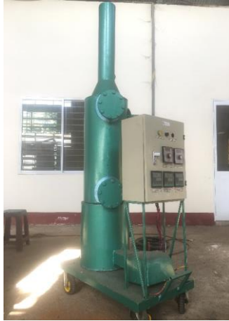
Hình 3. Lò nhiệt phân biomass sản xuất than hoạt tính
