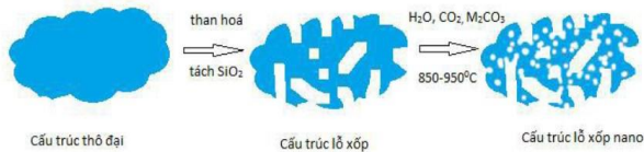
Hình 1. Quá trình sản xuất than hoạt tính
