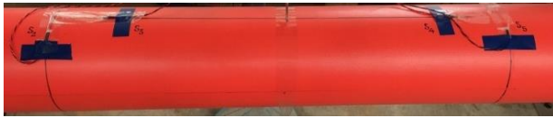
Hình 5. Sơ đồ bố trí các cảm biến đo biến dạng
