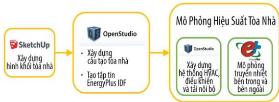
Hình 1. Tiến trình xây dựng mô hình công trình cho mô phỏng năng lượng bằng phần mềm OpenStudio
