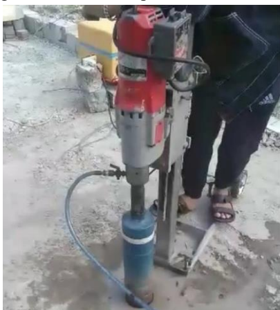
Hình 4. Khoan mẫu CPĐD GCXM ở hiện trường sau khi bảo dưỡng
