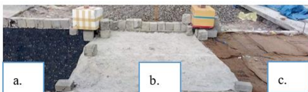
Hình 3. Các phương pháp bảo dưỡng CPĐD GCXM (a. Nhũ tương; b. Vải địa tưới nước; c. Bao bố tưới nước)
