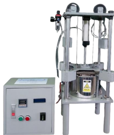
Hình 10. Máy thiêu kết kim loại dạng bột
