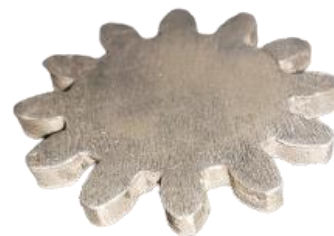
Hình 11. Chi tiết bánh răng sau quá trình thiêu kết
