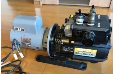
Hình 5. Máy hút chân không khô KRF25A
