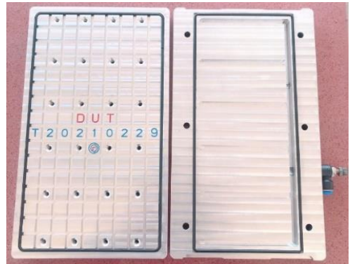
Hình 8. Tấm trên và tấm dưới của bàn hút chân không
