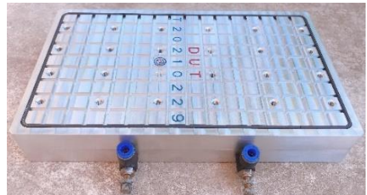
Hình 9. Bàn hút chân không hoàn thiện
