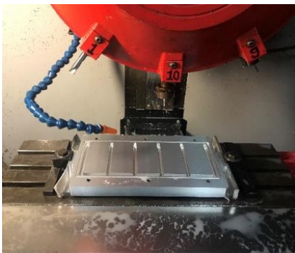
Hình 6. Gia công tấm dưới của bàn hút chân không
