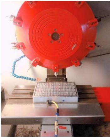
Hình 10. Kết nối bàn hút chân không với máy phay CNC
