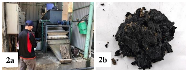
Hình 2. Máy ép bùn băng tải (2a) và mẫu bùn D&N (2b)
