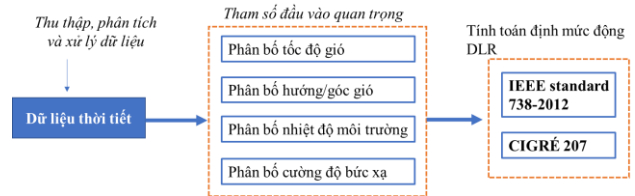
Hình 3. Phương pháp gián tiếp tính toán định mức tải nhiệt động (định mức tải thực tế - thời gian thực) DLR của đường dây
