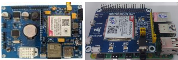
Hình 8. Phần cứng mạch trung tâm trạm loa: (a) Giải pháp 1 và (b) Giải pháp 2
