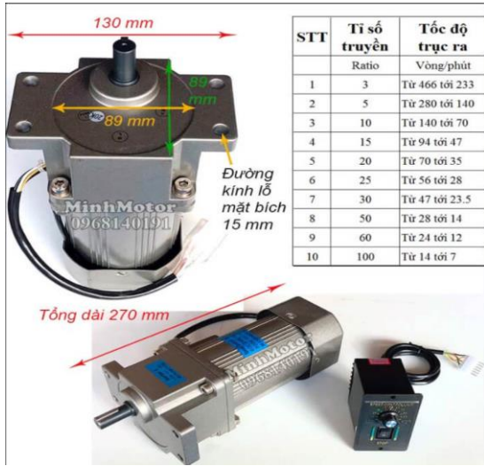
Hình 7. Mô tơ và bộ điều tốc mini
