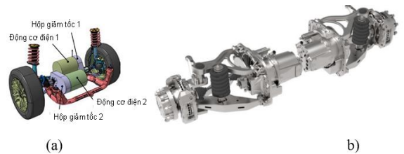
Hình 13. Hệ thống động lực 2 động cơ điện
