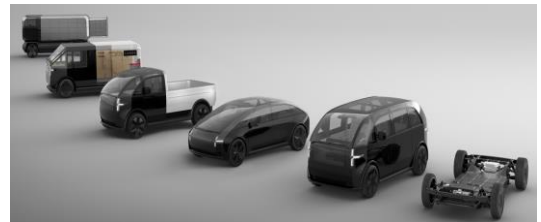
Hình 6. Các cấu hình xe điện trong thiết kế “skateboard” của Canoo
