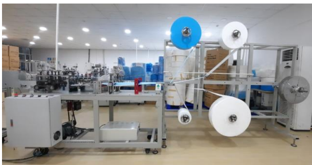
Hình 19. Mô hình máy thân khẩu trang y tế 4 lớp
