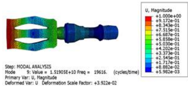
Hình 16. Biên độ dao động siêu âm 20 kHz
