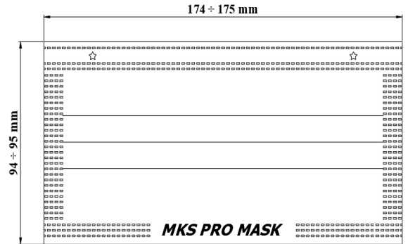
Hình 5. Thiết kế 2D thân khẩu trang y tế 4 lớp
