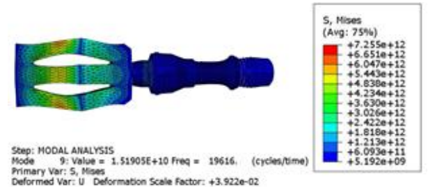
Hình 17. Ứng suất dao động siêu âm 20 kHz
